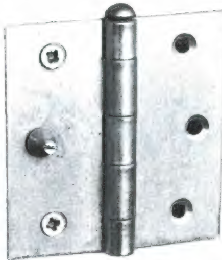
Dievenpin. De kop valt bij het sluiten van het scharnier in het tegenoverliggende scharniergat.
